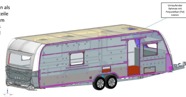
Darstellung Strukturbeuteil Bug und Heck aus LFI
