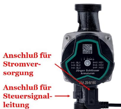
150. Über die Steuersignalleitung können dem pumpeninternen Mikroprozessor externe Steuerungssignale in Form von **Pulse-Width Modulation-Signalen** (Pulsweitenmodulation) zugeführt werden.
